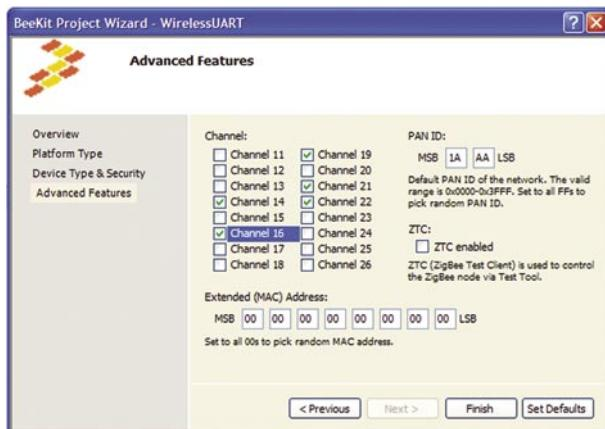
Рис. 6. Пример окна задания разрешенных частотных каналов, ID-сети и MAC-адреса устройства
